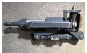
TIMÓN DE DIRECCIÓN CON BLOQUEO HIDRÁULICO (PARA DISTRIBUCIÓN CON PENDIENTES LATERALES)
