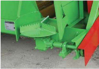
PLACA LOCALIZADORA CON PIE DE ALAMBRE TIPO MECÁNICO CON INCLINACIÓN MANUAL
