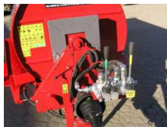
SISTEMA HIDRÁULICO INDE- PENDIENTE CON BOMBA Y DÉPÓSITO
