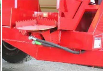
PLACA LOCALIZADORA CON PIE DE ALAMBRE TIPO HIDRÁULICO, CON INCLINACIÓN MANUAL
