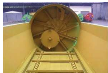
ESPARCIDOR DE TURBINA CON ROTOR DE CORTE Y CUCHILLA RASPADORA
